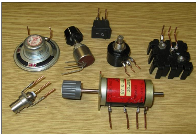
Větší součástky jsou opatřeny silnějšími vývody
